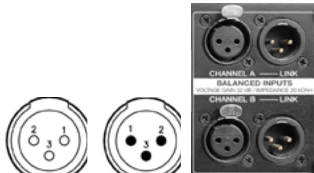
cable mallado se puede conectar un extremo de la malla al Pin1 del XLR y dejar el otro extremo sin conectar para conseguir cierto apantallamiento. La conexión del Pin 1 se recomienda únicamente si el equipo con la salida no balanceada tiene una conexión específica para la malla (tierra), separada de la masa o referencia de señal.
