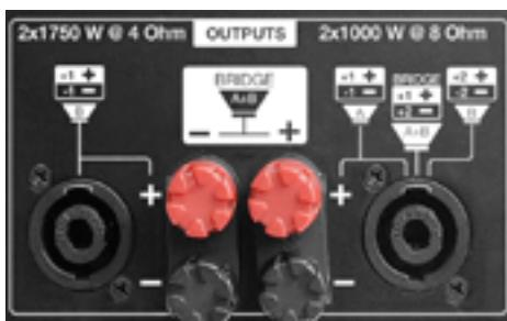
Se dispone de dos salidas para altavoces. Canal A y Canal B, provistas de una base para conector Speakon, y un par de Bornes para cada una.
