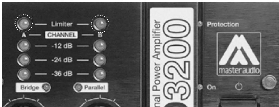
**¡Evítese mantener el LED LIMITER continuamente encendido!**
