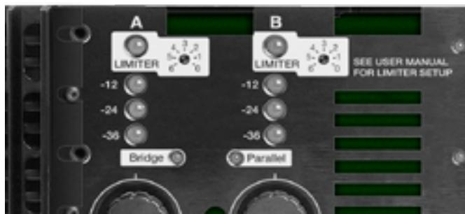
EL equipo se entrega con estos ajustes totalmente girados en el sentido de las agujas del reloj, entregando de esta manera la máxima potencia posible con la mínima distorsión gracias a su sistema anticliping. Cuando giramos los potenciómetros (ajustes) en sentido inverso, el correspondiente limitador se activara, y reduciendo la potencia al nivel determinado.
